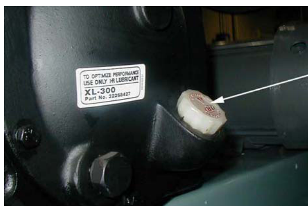
Figura 4-1 Localização do tampão de abastecimento de óleo da bomba de vácuo
